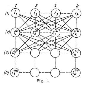
von dem Punkt ausgehen, auf den sie gesetzt sind, und führt das Resultat längs des entsprechenden Linienstückes zu den Punkten auf der wagrechten Linie (2). Man addiert alle in jedem einzelnen Punkt entstehenden Beiträge und hat damit die Größen  $i_1^{(2)} \cdots i_k^{(2)}$  gebildet und auf gleichbenannten Punkten der wagrechten Linie (2) angebracht.
