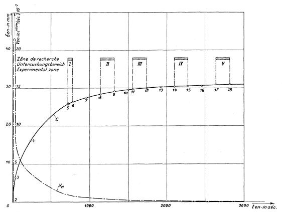
Fig. 4.  $c = \left\{ \begin{array}{l} \text{Courbe de la flèche en fonction du temps.} \\ \text{Durchbiegungskurve in Funktion der Zeit.} \\ \text{Curve of bending as a function of the time.} \\ \end{array} \right. \\ \nu_{M} = \left\{ \begin{array}{l} \text{Courbe de la vitesse moyenne du déplacement.}} \\ \text{Kurve der mittleren Durchbiegungsgeschwindigkeit.} \\ \text{Curve of the mean speed of bending.} \end{array} \right.$
