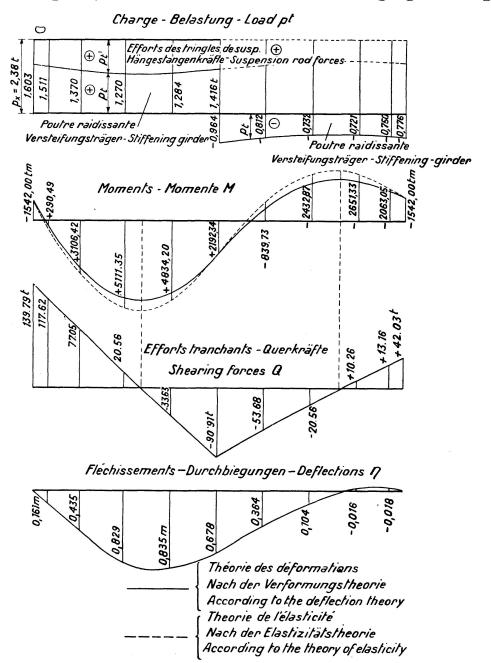
Fig. 14. Résultats pour charge sémi-latérale avec  $p_x$ . Ergebnisse bei halbseitiger Belastung mit  $p_x$ . Results when loaded with  $p_x$  on half the span.
