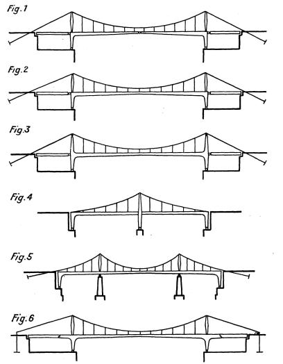
Fig. 1-6. Dispositions de l'ouvrage. Tragwerkausbildungen. Examples of supporting structures.
