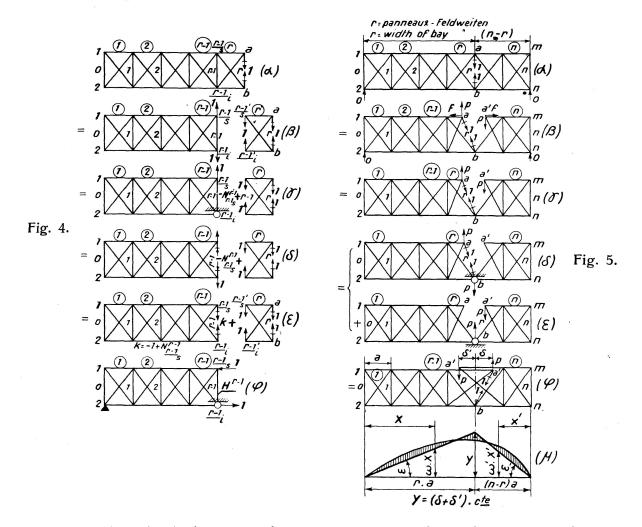
La déformée de la poutre à r panneaux peut s'obtenir comme suit: on peut déterminer d'abord la déformée de la poutre r-1 panneaux (fig.  $4,\beta$ ), puis prolonger cette déformée dans le panneau r et ramener l'appui b sur son horizontale initiale.
