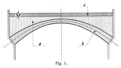
Um die Gleichung der Stützlinie aufstellen zu können, wird diese Zeichenarbeit mathematisch vollführt<sup>2</sup>). Die Belastungsfläche wird zuerst mit einer Parabel dritten Grades abgeschlossen, da diese mit der Stützlinie nahezu übereinstimmt (Fig. 2, I. und II.):
