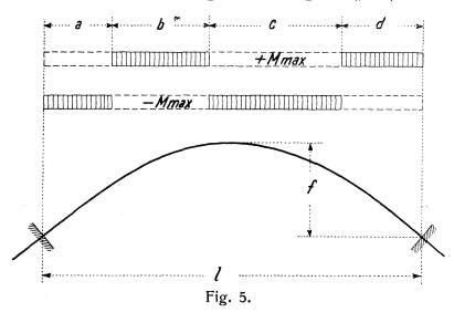
Die Tabelle 2 enthält z. B. die Einflußzahlen der Reaktionen eines eingespannten Bogens, wenn der Achsenbeiwert  $\gamma = 3.0$ , der Querschnittsbeiwert k = 2, und die Tabelle 3 ergibt die Reaktionen eines Zweigelenkbogens. falls die Achsenbeiwerte 0, 1,2, 3,0, 5,0 und 8,0 sind. Ähnliche Tabellen für andere Beiwerte  $\gamma$  und k können ebenso einfach berechnet und aufgestellt werden 5).
