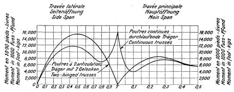
Comparaison des moments maxima pour la charge accidentelle et la température pour une poutre en treillis de raidissement continue et ceux pour une poutre avec des articulations sur les appuis médians.
