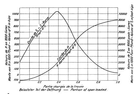
Courbes des valeurs ti et T, pour une charge répartie uniformément, avançant sur la travée principale et pour la plus haute température. Il und T, - Kurven für vorwärts schreitende gleichmässig verteilte Last in der tlaupt - Deffnung bei höchster Temperatur.
