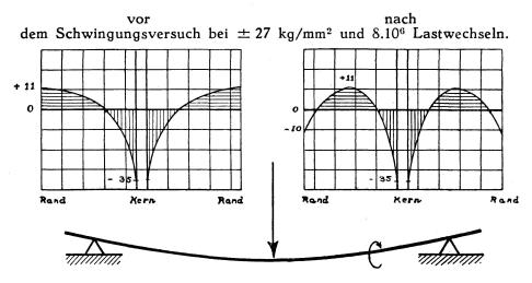
Abbau von Eigenspannungen durch Biegeschwingungsbeanspruchung.
