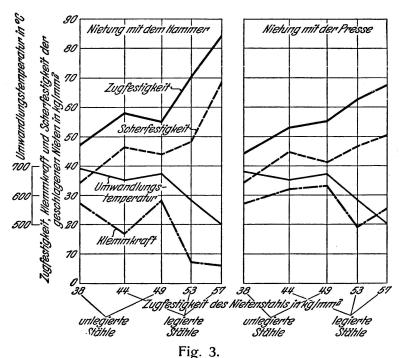
Festigkeitseigenschaften und Klemmkraft von Nieten aus verschiedenen Stählen (Durchmesser der Nieten 19 mm, Klemmlänge 96 mm, Nietdruck rd. 120 kg/mm²).
