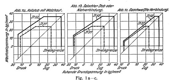
Dauerzugfestigkeit von St 37 und St 52 (nach K. Schaechterle). Résistance à la faitique par traction des aciers St 37 et St 52 (d'après K. Schaechterle). Fatigue tensile strength of St 37 and St 52 (according to K. Schaechterle).
