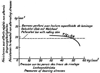
Résistance aux efforts répétés non alternés dans un assemblage en acier St.37 avec rivets en acier St. 34, en fonction des pressions sur les parois des trous des rivets.
