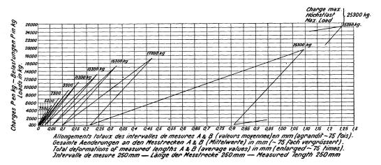
Diagramme (échelle disproportionnée) des allongements totaux à l'essai statique de traction par rapport aux charges.
