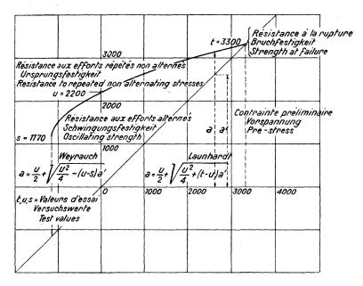
Courbe des résistances à la fatigue d'après Launhardt - Weyrauch. Arbeitsfestigkeitskurve nach Launhardt - Weyrauch. Launhardt - Weyrauch' working strength curve.
