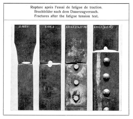
dichter Nietbesetzung steigt die Dauerfestigkeit der Nietverbindung über die des gelochten Stabes. Nach  $\tau \ge 1,0$  setzt ein starker Spannungsabfall ein. Bei Lochwanddrücken  $\sigma_l$  zwischen 1,5 und 2,0  $\sigma$ , sowie  $\tau = 0,80$  ist die Abnahme der Dauerfestigkeit gering, überschreitet der Lochwanddruck jedoch den Wert 2,5  $\sigma$ , so tritt ein starker Spannungsabfall ein (Fig. 40).
