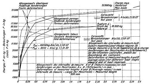
Comparaison des allongements totaux et permanents mesurés par essais statiques et de fatigue.
