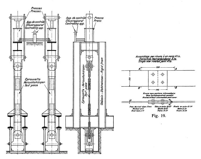
Machine pour essais de longue durée. <u>Dauerprüfmaschine.</u> Fatigue testing machine.
