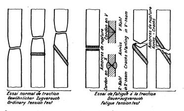
Barreaux plats avec assemblages bout à bout avec cordons normaux et inclinés par rapport à l'axe. <u>Flachstab mit Stumpfstoss guer u. schräg zur Hauptzugrichtung.</u> Flat with butt-weld, at right angle or askew.
