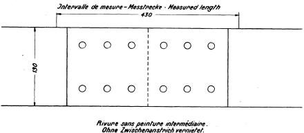
380 Tôles en acier St.37 - Rivets en acier St.34 Bleche St.37 Niete St.34 Plates St.37 Rivets St.34 Trou de rivet diam 17mm Nietloch ø 17 Rivet hole ø 17 mm
