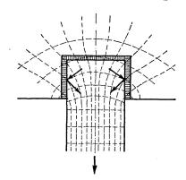
Lignes de force dans les cordons d'angle latéraux et Frontaux. <u>Kraftfluss durch Stirn - & Flankenkehlnähte.</u> Stress-field through frontal and lateral quarter round seams.
