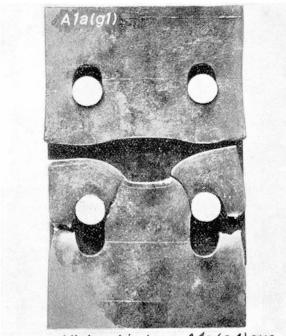
Nietverbindung A1a (g,1) aus St37 nach dem Bruch und nach Wegnahme der einen Lasche (Schließkopfseite).
