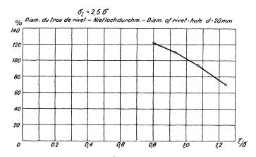
Résistances aux efforts répétés non alternés dans un assemblage en acier St.37 avec rivets en acier St.34 pour 6; = 2,56 et T = 0,8 à 1,25 6 en % de la résistance aux efforts répétés non alternés du barreau perforé.
