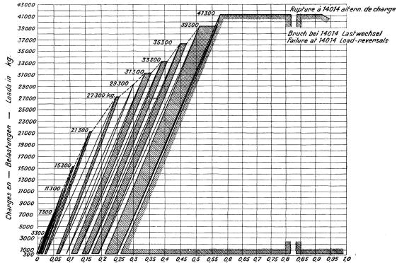
Allongements totaux en mm des intervalles de mesure A et B (valeurs moyennes). Intervalle de mesure 430 mm. Gesamte Aenderungen an den Messtrecken A & B (Mittelwerte) in mm. Länge der Messtrecke 430 mm. Total deformations of the measured length A and B (average value) in mm.
