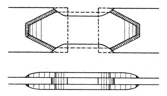
Assemblages à couvre-joints avec cordons de soudures en biais longs et cordons de soudures frontaux courts retouchés pour obtenir une grande resistance à la fatique.
