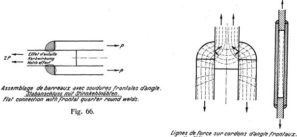
Lignes de force sur cordons d'angle frontaux <u>Kraftfluss durch Stirnkehlnähte.</u> Stress-field in frontal quarter round welds.
