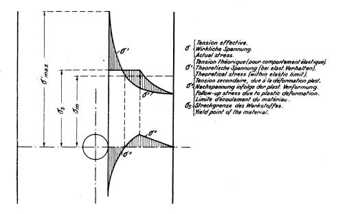
Egalisation des tensions dans le barreau plat perforé par déformation plastique du bord de trou . <u>Spannungsausgleich beim gelochten Flachstab infolge den plastischen Verformung am Lochrand</u>. Stress equilibrium in the perforated flat bar due to the plastic deformation of edge of hole.
