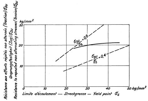
Résistance aux efforts répétés non alternés (Traction) en fonction de la limite d'ecoulement.
