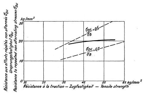
Résistance aux efforts répétés non alternés en fonction de la résistance à la traction . (Barnes perforées avec texture superficielle du laminage).
