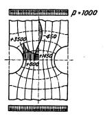
Contraintes dans le barreau plat avec entailles latérales. <u>Spannungszustand des Flachstabes mit</u> <u>seitlichen Kerben.</u> Stress distribution in the flat bar provided with lateral notches.
