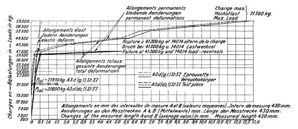
Comparaison des allongements totaux et permanents, mesurés par essai statique et de fatigue.
