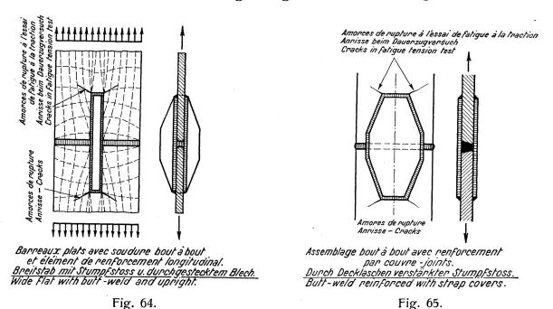
gang an den Laschenstirnen gemildert ist — lassen sich Dauerfestigkeiten erreichen, die denen von Nietverbindungen entsprechen und sogar einem guten Stumpfstoß mit V- oder X-Nähten gleichwertig sind.
