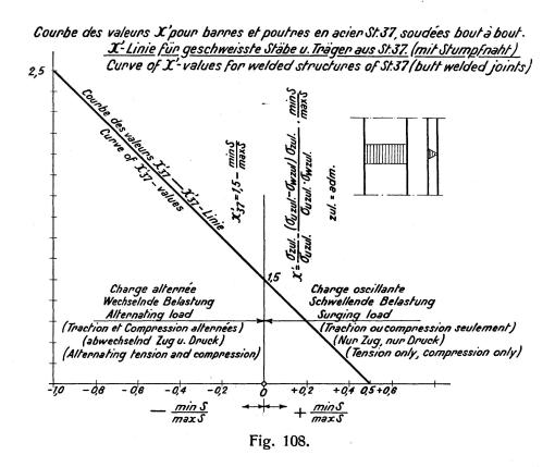
Für die praktische Anwendung empfiehlt es sich, den erforderlichen Querschnitt durch Einführung einer ideellen Stabkraft S auf die Grundspannung  $\sigma_{zul}$  zu beziehen.
