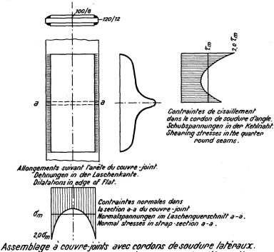
Répartition des contraintes d'après la mesure des déformations sur très faibles longueurs, méthode de Gaber . Laschenverbindung mit flankennähten — Spannungsverteilung aus Dehnungsmessungen mit sehr kleinen Messlängen, nach Gaber . Strap-joint with lateral seams — Stress distribution based on measurements of dilatation with very small measured lengths.
