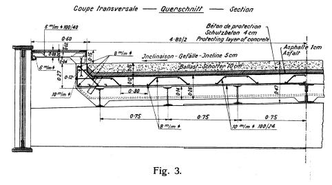
war daher erforderlich, eine sichere Verbindung zwischen der Eisenbeton-Fahrbahnplatte und den Längsträgern herzustellen; zu diesem Behufe wurden Querträger in jedem Viertel der Öffnung der Längsträger angeordnet, welche durch die infolge der Zusammenwirkung der Längsträger und der Eisenbeton-Fahrbahnplatte entstehenden horizontalen Schubkräfte auch auf Biegung be-
