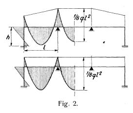
seine Tragfähigkeit erschöpft; die rechnungsmäßig vorausgesetzte *v*-fache Sicherheit ist tatsächlich genau vorhanden, die Sicherheit des Einzelquerschnittes stimmt mit der Sicherheit des Gesamttragwerkes vollkommen überein. Eine plastizitätstheoretische Untersuchung erübrigt sich, die Elastizitätstheorie ist zur Bemessung solcher Konstruktionen ausreichend.
