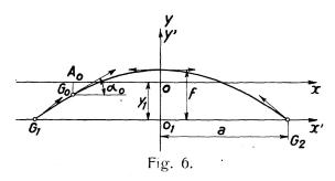
Pour déterminer l'équation de la fibre moyenne dans ce système on considérera les axes provisoires  $0_1$  x' y' constitués par la verticale de la clé et la ligne des appuis. a désignant la  $\frac{1}{2}$  portée, f la flèche, m le paramètre
