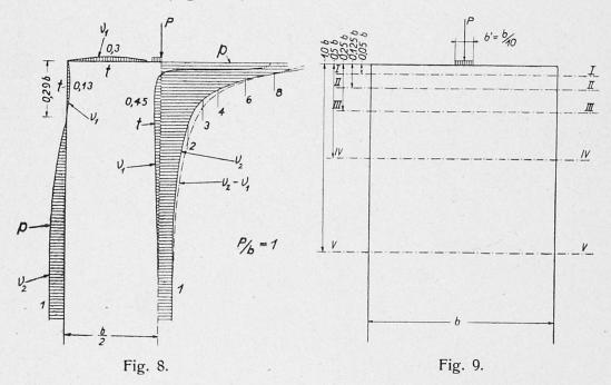
2. Les contraintes principales  $\nu_1$  sont des tractions proprement dites en tous les points du modèle, sauf pour trois zones dont deux entourent les points positifs singuliers à l'intérieur du modèle et dont la troisième se trouve au voisinage immédiat de la section rétrécie; pour ces zones, les contraintes principales  $v_1$  sont des compressions (figure 6).
