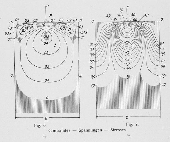
La connaissance des différences entre les tensions principales en tous les points du modèle  $(\nu_1-\nu_2)$  permet la détermination directe des tensions principales  $\nu_1$  et  $\nu_2$ , par intégration des équations suivantes
