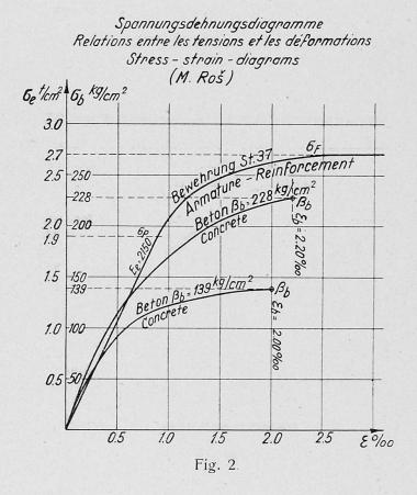
mit Prismendruckfestigkeiten von 139, bezw. 228 kg/cm² und einer Bewehrung in normalem Flußeisen St. 37 durch. Die Spannungsdehnungsdiagramme dieser drei Materialien sind in Abb. 2 dargestellt¹).
