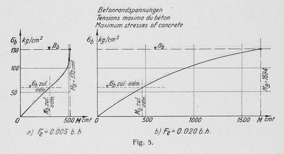
Liegt die Eisenspannung im Bruchzustand des Balkens zwischen der Proportionalitätsgrenze und der Fließgrenze, so kann das Bruchmoment  $M_B$  auf dem einleitend angedeuteten Wege der wiederholten Schätzung von x bestimmt werden.
