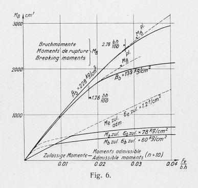
rücksichtigt. Aus der Gegenüberstellung der beiden Beispiele zeigt sich, daß das Verhältnis  $\frac{M_B}{M_{b,zul.}}$ , also die Sicherheit eines mit Rücksicht auf die zulässige Betonbeanspruchung bemessenen Eisenbetonbalkens je nach der
