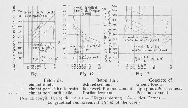
Par la comparaison des valeurs obtenues ici avec celles trouvées pour des piliers non armés préparés dans les mêmes conditions et avec le même matériau, ainsi que pour d'autres piliers ayant la même armature longitudinale mais des étriers simples et sans spirale, on a pu déduire les valeurs des coefficients m et  $m_i$  relatifs à l'armature longitudinale et à la spirale, tels qu'ils figurent dans la formule bien connue:  $P_r = K_b$  ( $F_k + m F_j + m_i F_i$ ).
