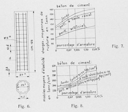
Les charges de rupture et les résistances augmentent avec l'augmentation du pourcentage d'armature des spécimens; il résulte des essais que dans les piliers octogonaux à étriers circulaires, la résistance augmente plus rapidement, que dans ceux de section carrée, probablement parceque les étriers circulaires déterminent une action de frettage du béton plus efficace que les étriers carrés, bien qu'ils n'atteignent pas l'efficacité plus élevée de l'enroulement en spirale.
