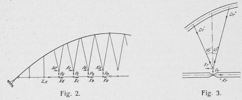
so ist dies nicht der Fall. Um die Konstruktion innerlich statisch bestimmt zu machen, denken wir uns die Verbindung zwischen Untergurt und den Knotenpunkten der schräggestellten Hängestangen gelöst und führen die Reaktion des Untergurtes auf die Knotenpunkte  $X_a, X_b$ . als statisch überzählige Größen ein, siehe Fig. 2. (Um das Hauptsystem deutlicher hervortreten zu lassen, sind die Hängestangknoten getrennt von den Knoten des Untergurtes gezeichnet.)
