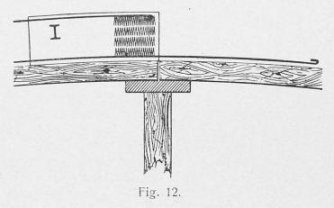
Cette réduction est due essentiellement à l'aplatissement du plomb qui recouvrait les coins de maintien.
