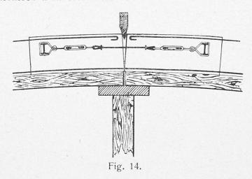
Avant de décintrer, on a enlevé d'abord la poix bouchant les joints, puis les coins de maintien. D'un examen minutieux des ouvertures, il est résulté que les joints n'avaient pas bougé. Au moment où le cintre s'abaissa, les ouvertures se refermèrent progressivement et complètement. Les frais pour ces opérations, comparés au prix de revient de l'ouvrage complet, sont vraiment insignifiants.
