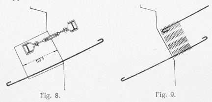
Après avoir préparé les choses comme nous venons de l'indiquer, on a attendu la prise complète du béton. Ces travaux préliminaires étant terminés, on a enfilé les coins dans le joint d'intrados. Dans la figure, les coins ne sont pas dessinés à l'echelle réelle. En réalité, ces coins avaient une longueur de 80 cm. sur 16 cm. de largeur. La partie tranchante était aussi mince qu'une lame de couteau, tandis que l'épaisseur du coin, à l'extrémité opposée, mesurait 1 cm.
