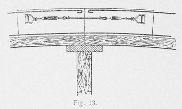
Après avoir poli la surface du joint et fixé une plaque en plomb, on a coulé le deuxième demi-arc. Ce travail terminé, on a écarté les deux bords du joint à l'aide des coins d'ouverture pour introduire ensuite les coins de maintien. Une fois en place, on a reserré les deux bords au moyen des extenseurs fixés aux poutrelles, obtenant ainsi une ouverture à l'extrados de 7,5 mm.
