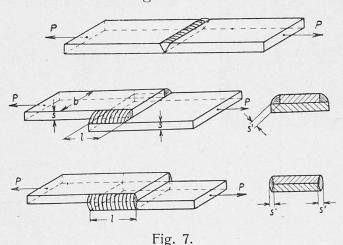
La soudure bout à bout est la meilleure pour souder un assemblage. Soudures frontales et soudures latérales.
