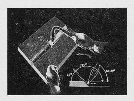
Position du chalumeau et de la baguette d'apport dans la soudure à droite.
