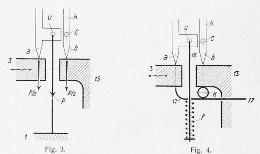
Falsche und richtige Befestigungsweise eines Hebeldehnungsmessers an der Mikrometerbank— Exemples de montages convenable et défectueux d'un extensomètre à levier sur le banc micrométrique — Wrong and Right Methods of fixing a Lever Extensometer on the Micrometer Bench.
