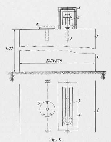
Fixpunkt zur Prüfung von Setzklinometern — Dispositif pour le contrôle de clinomètres à pied — Checking Device for Seat-Clinometers.
