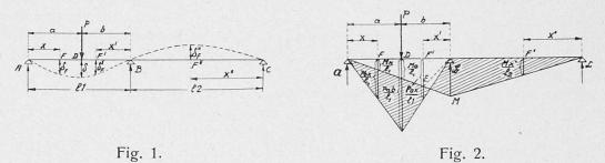
Um die dynamische Wirkung zu untersuchen, benötigt man die statischen Durchbiegungen des gegebenen Trägers für die ruhende Last am Fallorte, was unter I. berechnet werden soll.
