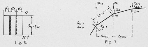
Als Unbekannte des statisch unbestimmten Systems wählen wir die Momente  $X_n(x)$  und bringen diese an dem Gelenkwerk — das wir ja als Grundsystem gewählt haben — neben den gegebenen Lasten  $P_n$  als äußere Kräfte an. Halten wir für die  $X_n$  den in Abb. 7 angedeuteten Drehsinn fest, so ergeben sich die von  $X_n$  herrührenden Knotenlasten  $\pi_n$  zu
