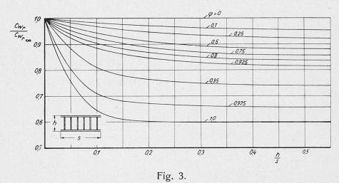
Widerstand ebener Gitterfachwerke. Abhängigkeit des Widerstandes vom Seitenverhältnis h/s und vom Völligkeitsgrad g. (Zweidimensionale Strömung).  $c_{w_{r\infty}}$  kann der Fig. 2 entnommen werden.
