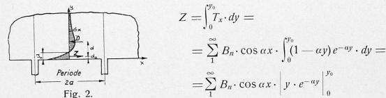
Hierbei ist die  $y_0$  der Abstand der neutralen Achse vom Rande. Zur Abkürzung wird gesetzt:
