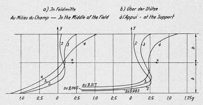
Fig. 8. Biegungskräfte  $T_x$  — Efforts de flexion  $T_x$  — Bending Stresses  $T_x$ .
