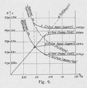
zu entnehmen ist. Damit ergibt sich eine sehr einfache und leicht anwendbare Dimensionierungsregel für die Bestimmung der notwendigen Eiseneinlagen. Die Größe der Längskraft Z ist gegeben einerseits durch den Navier'schen
