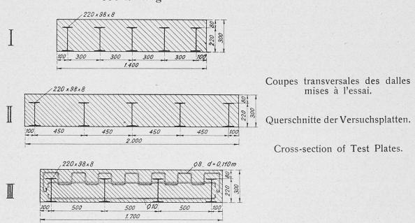
Ces dalles reposaient sur deux massifs parallèles de béton à 200 k. de ciment ayant 1.00 m. d'épaisseur et 2.20 m. de longueur reposant sur semelles
