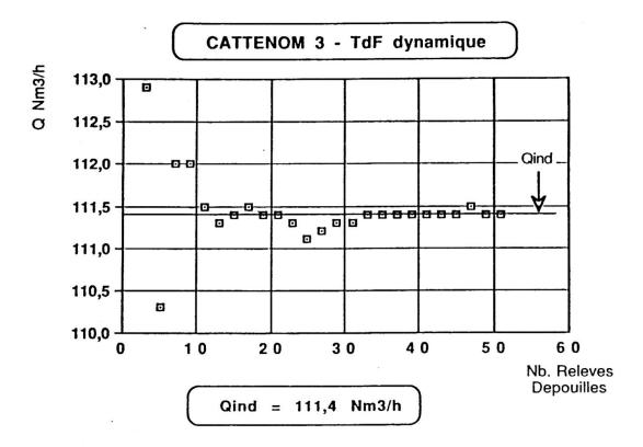
Figure 6 : Incidence du nombre de relevés dépouillés sur la détermination du débit de fuites "indirectes".
