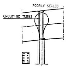
Fig. 13 - POORLY SEALED GROUTING TUBES
