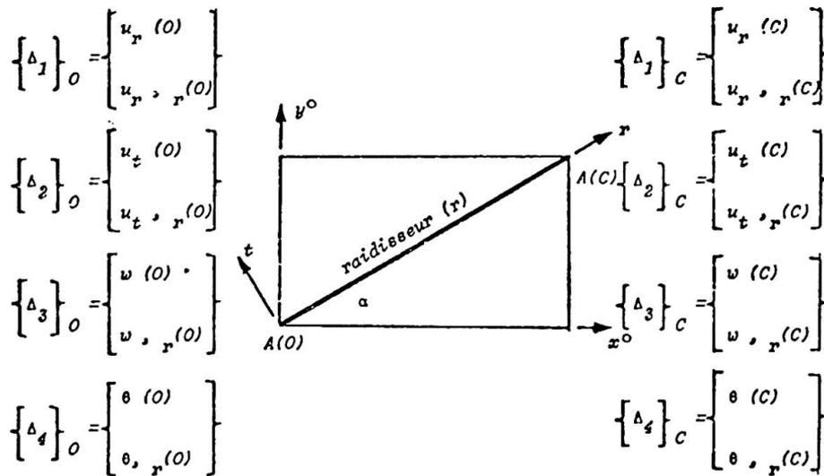
Posons :  $\left\{ \Delta_i \right\}^r = \begin{Bmatrix} \Delta_i O \\ \Delta_i C \end{Bmatrix}$  composantes de déplacement de  $A(O)$  et  $A(C)$  dans  $(r, t, z)$
