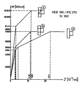
Fig. 2: M-3 Kurven für den geschweißten Knoten HEB 180. IPE 270, St 360;
