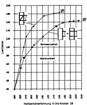
Fig. 5: Lastverformungskurve für einen verschieblichen Rahmen
