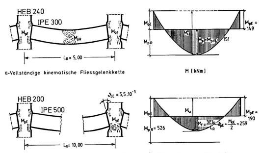
b-Rotationsbeschränkung verhindert die Ausbildung eines Fliessgelenkes in Riegelmitte
