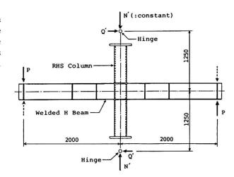
Fig.3 Cruciform subassemblage
