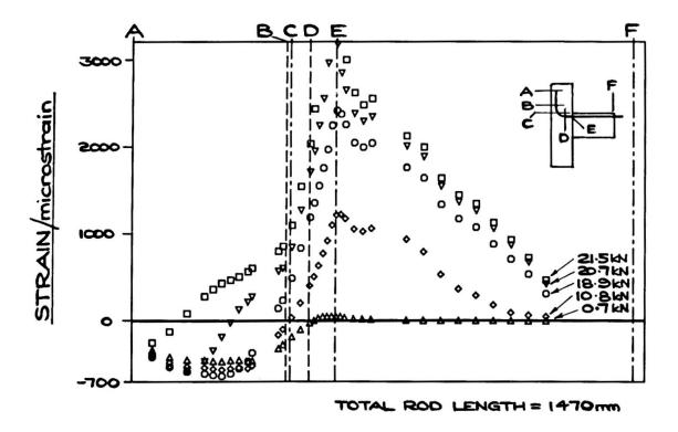
Fig2: SPECIMEN 2-TOP BEAM ROD
