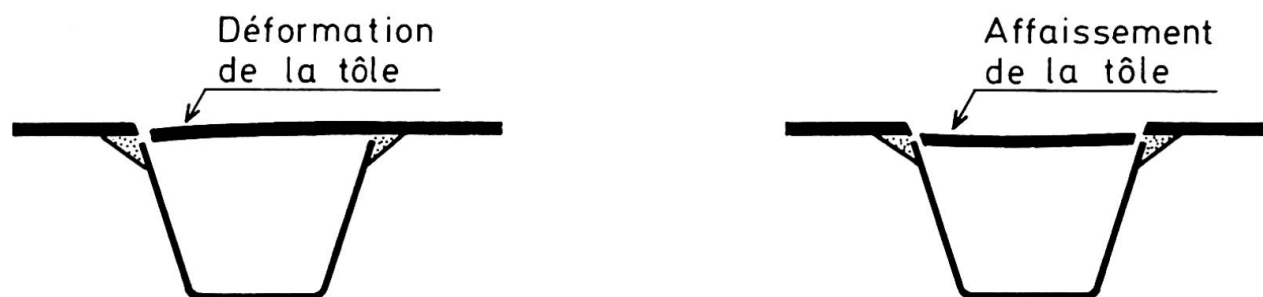
Fig.4 - Déformation des lèvres des fissures et affaissement de la tôle
