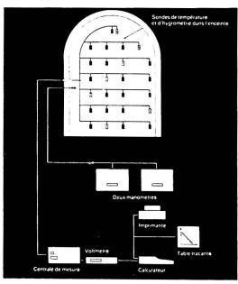
Schéma du dispositif de mesure du taux de fuite
