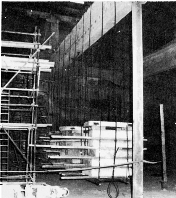
Fig.1 Prüfung eines Stahlbeton-Kranbahnträgers
