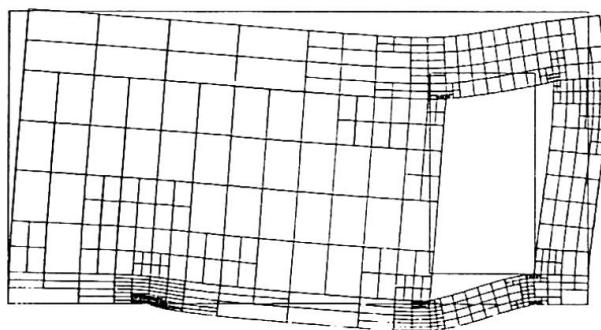
Fig.2 Adaptiv verfeinertes Finite-Element-Netz
