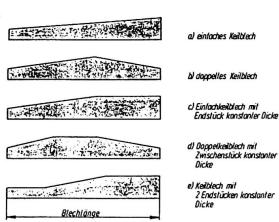
Bild 1: Verschiedene Möglichkeiten von Längsprofilen bei Grobblechen
