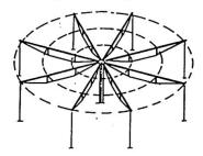
kreisförmiger Grundriß mit radial angeordneten Obergurten
