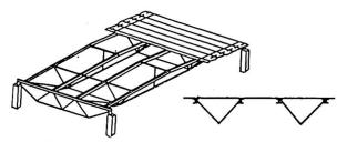
Unterspannung mit räumlicher Tragwirkung
