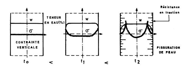
Figure 2: micro-fissuration de peau du béton ordinaire [5]
