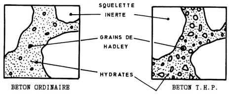
Figure 1: constitution des bétons à l'état durci.
