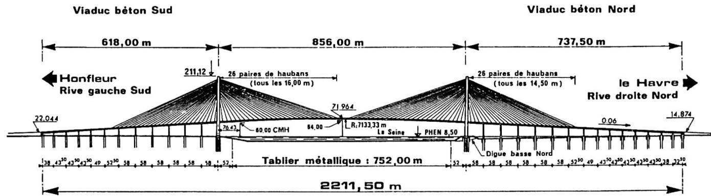
Figure 1 : Elévation longitudinale du Pont de Normandie.
