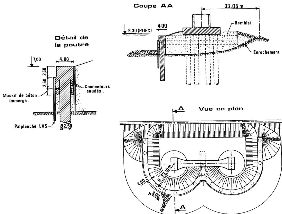
Figure 2 : Schémas de la protection du pylône Nord.
