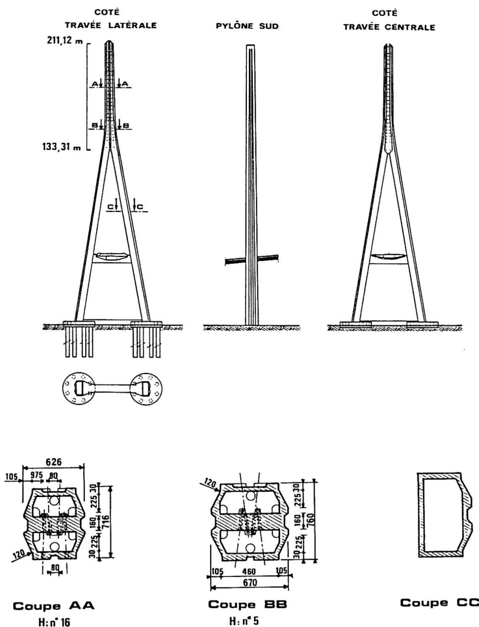
Figure 5 : Schémas de définition des pylônes.
