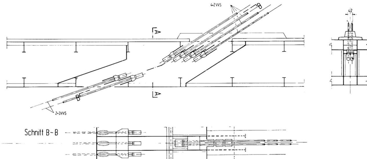
Fig. 10 Verankerungsbereich von Über- und Unterspannung im Brückendeck
