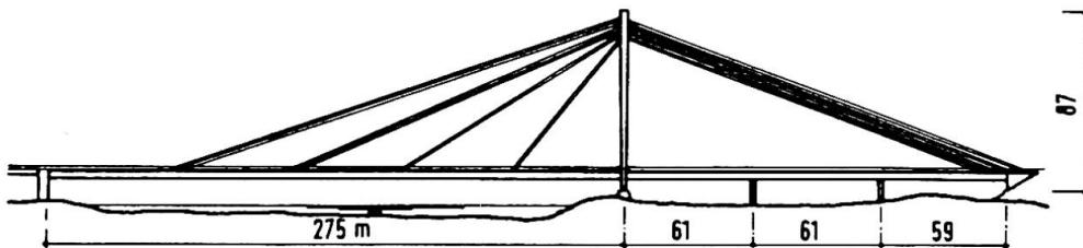
Fig. 3 Einhüftige Schrägseilbrücke über den Rhein bei Speyer
