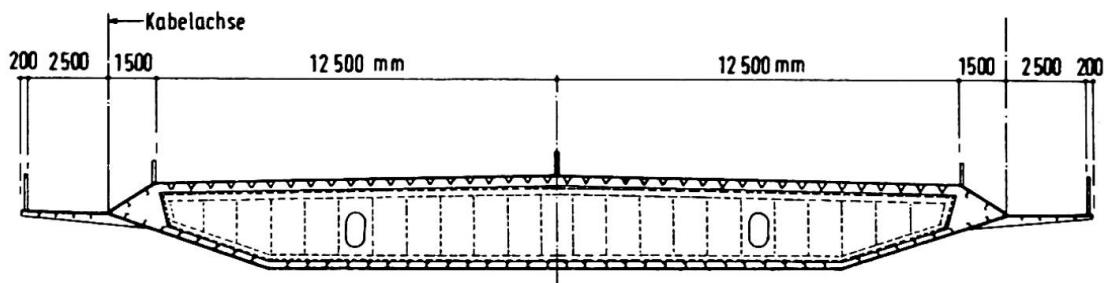
Fig. 2 Querschnitt der ersten Bosporusbrücke
