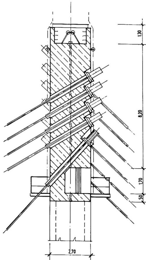
Fig. 9 Seilverankerung am Pylonkopf
