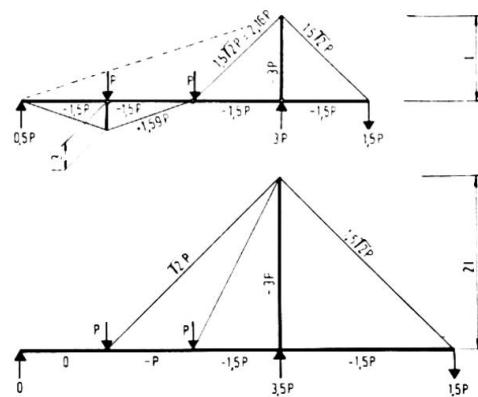
Fig. 4 Kräfte bei doppelter Pylonhöhe ohne Unterspannung
