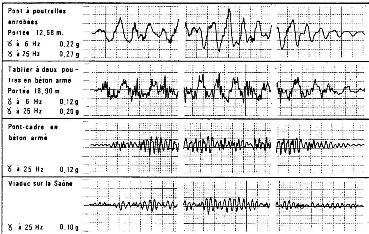
Fig. 4 Mesures d'accélération sur divers types d'ouvrages
