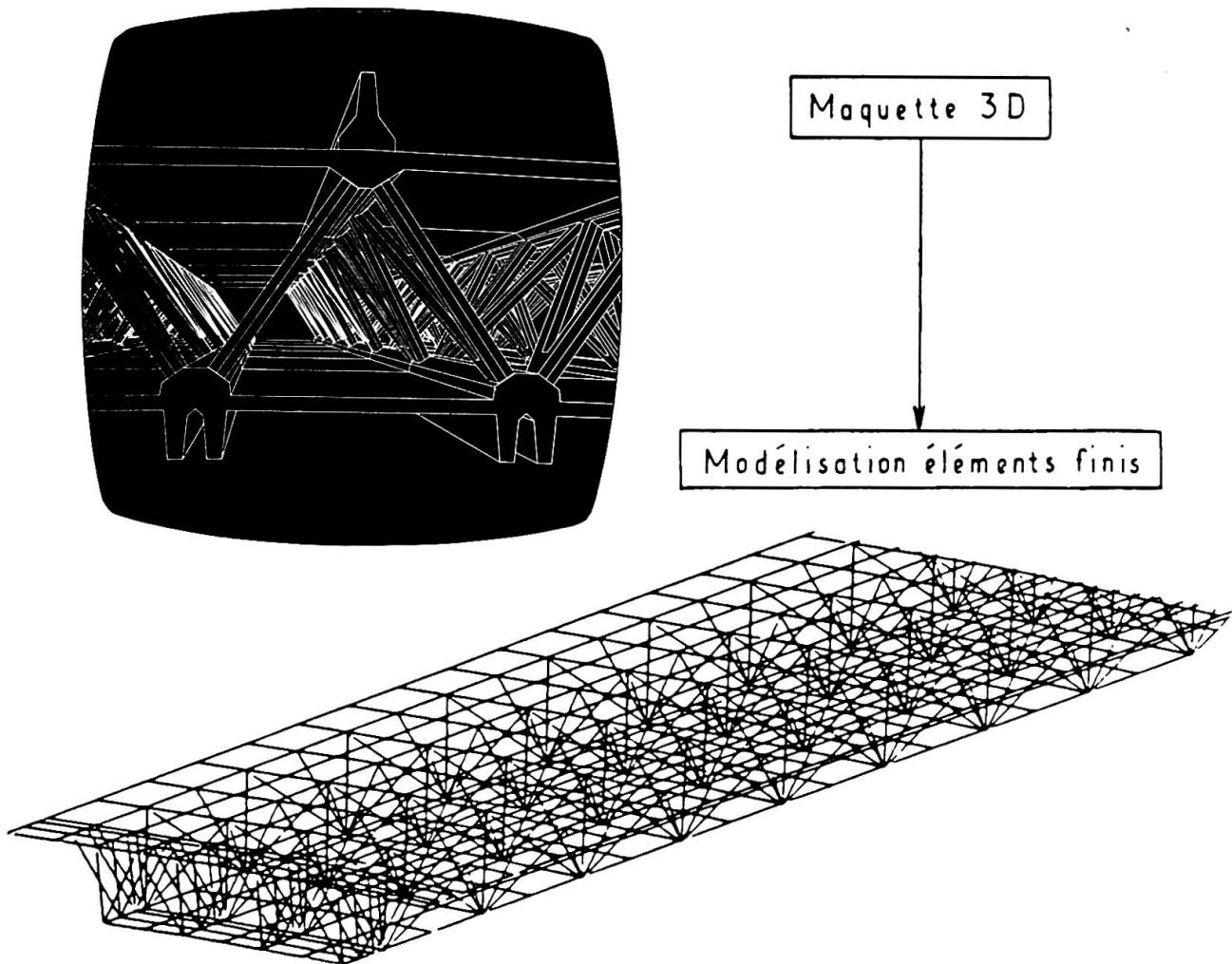
A partir des résultats de l'analyse, l'utilisateur produit l'ensemble des documents de ferrailage (plans, détails, nomenclatures). Il contrôle les procédures de montage des aciers (cheminée de betonnage, préfabrication de panneaux, etc...).
