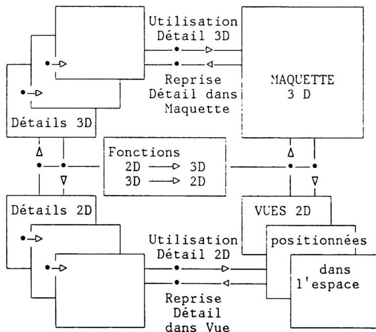
Le logiciel associe des fonctions 3D sophistiquées (algèbre générale des volumes et des surfaces), et des fonctions spécifiques pour les "objets du bâtiment" les plus utilisés.
