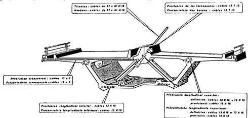
Figure 6 : Principe de précontrainte du tablier
