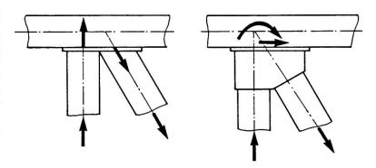
Figure 9: Transfert des efforts dans le cas d'un nœud comportant des goussets (à droite), et sans goussets (à gauche).
