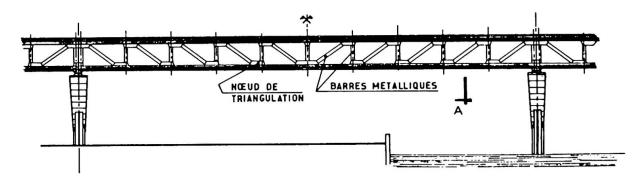
Figure 6 : Coupe longitudinale d'un pont à âmes en treillis métallique.
