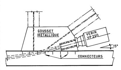
Figure 8 : Gousset métallique servant à l'ancrage d'un câble situé dans le hourdis inférieur.
