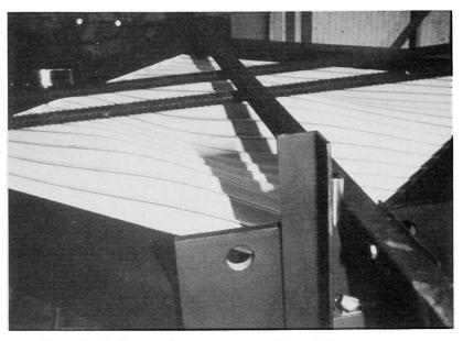
Photo 2 : Voilement d'un panneau en tôle ondulée.
