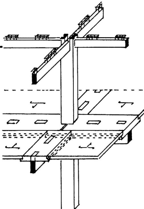
Fig. 8 Einriegel-Dübelverbundsystem
