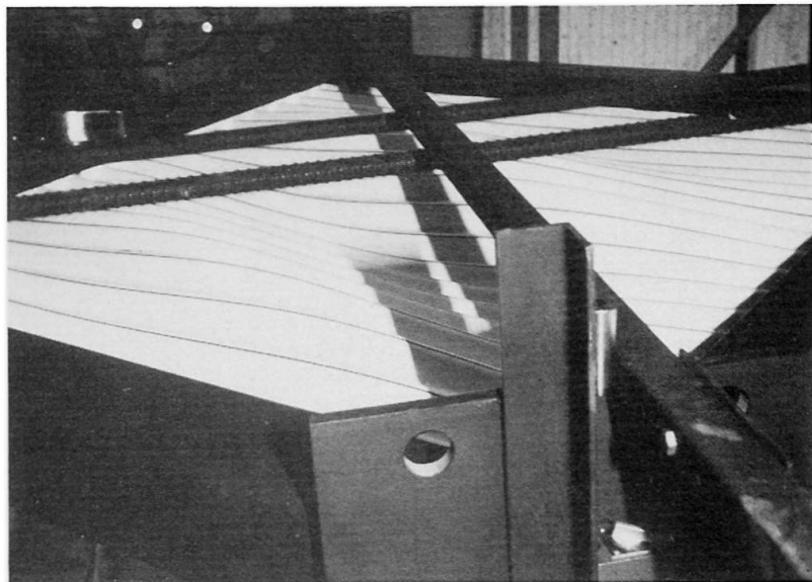
Photo 2 : Voilement d'un panneau en tôle ondulée.
