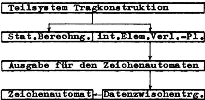
Fig. 4 Arbeitsschema des Teilsystems Tragkonstruktion
