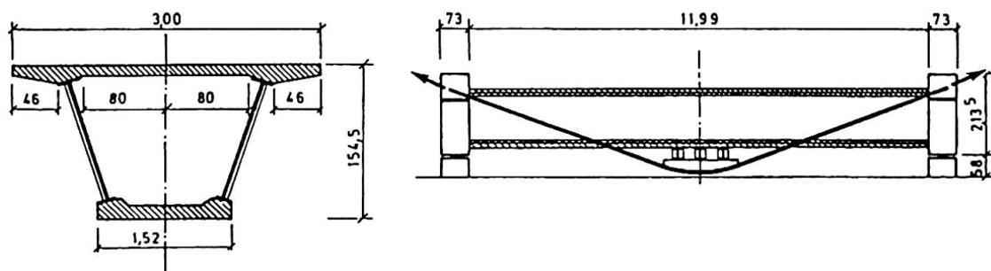
Figure 5 : Schéma de la maquette d'essai d'Asnières.
