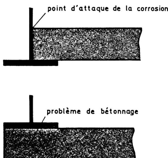
Figure 2 : Problèmes posés par la position du hourdis inférieur.
