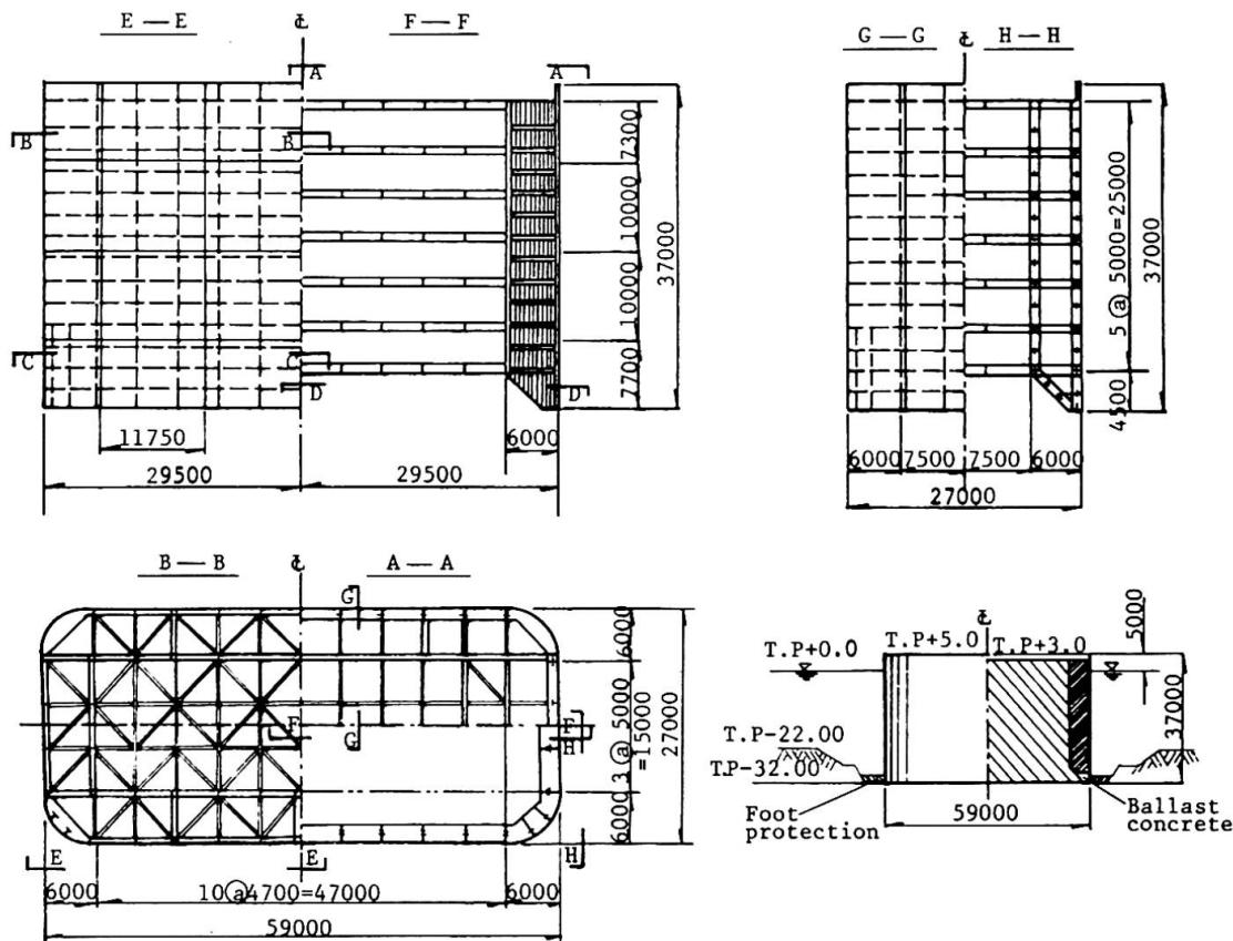
**Fig.2 Steel caisson**
