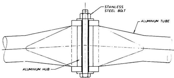
FIGURE 4 - TRIODETIC JOINT
