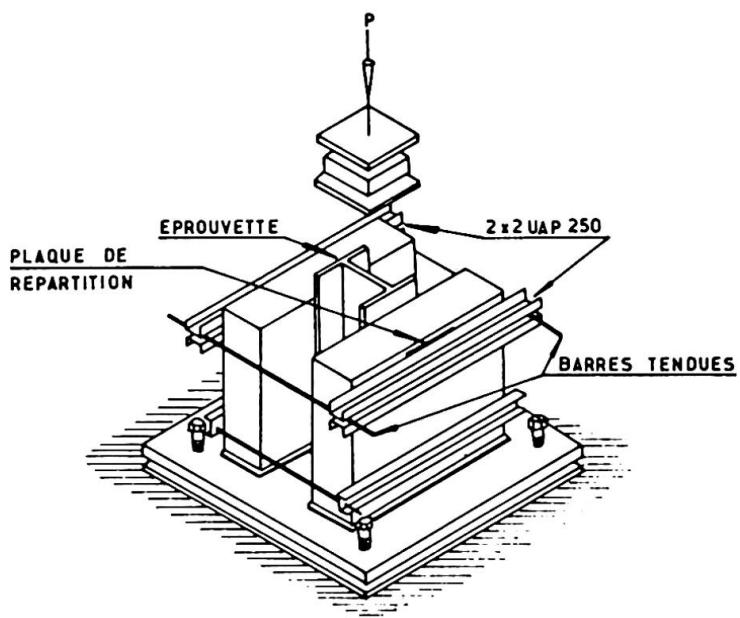
Figure 10 : Montage des essais de connecteurs.
