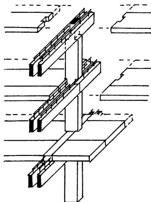
**Fig. 6** Doppelriegel-Verbundsystem
