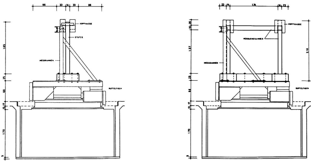
Fig.1 Erdbebensimulationsversuch mit Stahlbetonkragarm und -rahmen
