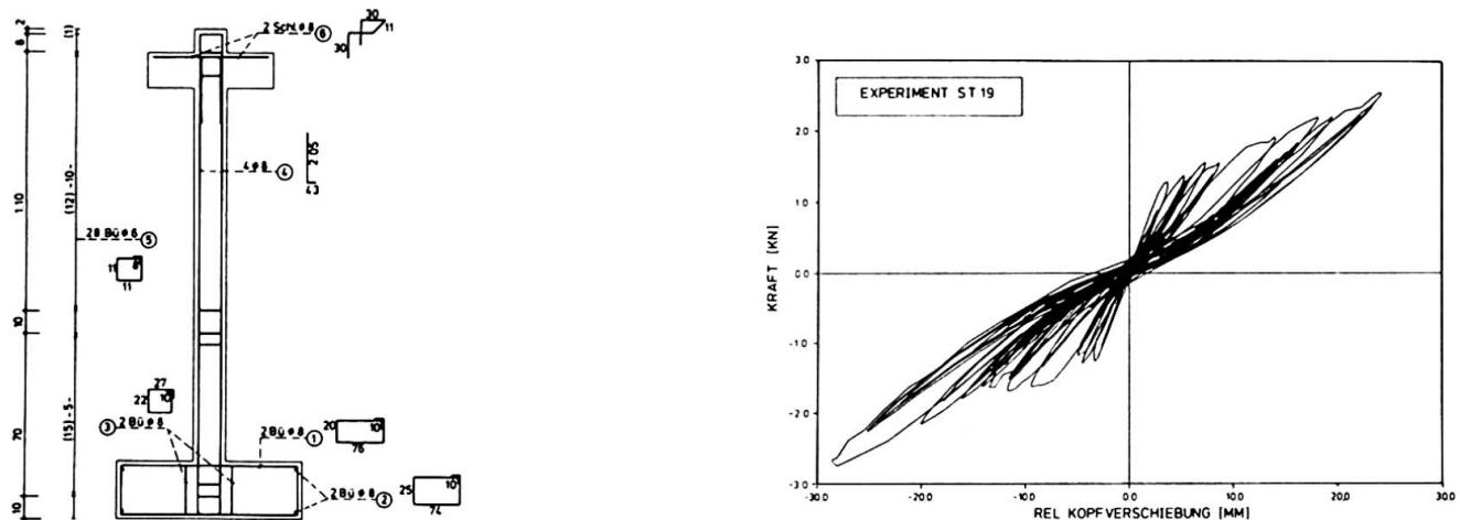
Fig.2 Nichtlinear-elastisches Bauteilverhalten des Stahlbetonkragarms
