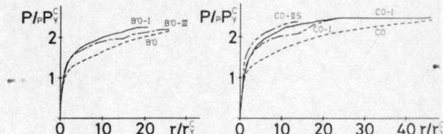
Fig. 4 Load-Shear Deformation Curves
