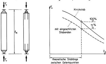
wird jedoch übersehen, dass die Anschlussart ebenfalls einen ungünstigen Einfluss auf die Druckkraft bzw. auf die Knicklast ausübt.
