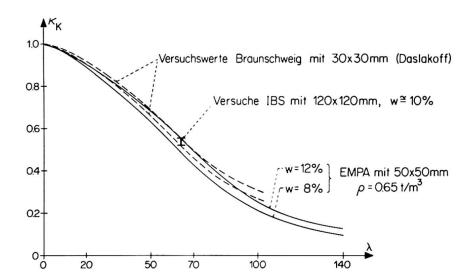
Abb. 8 : Vergleich von Versuchsdaten
