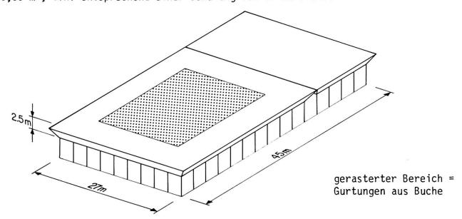
Abb. 9 : Schematische Darstellung des Stabrostes für die Mehrzweckhalle Arbon
