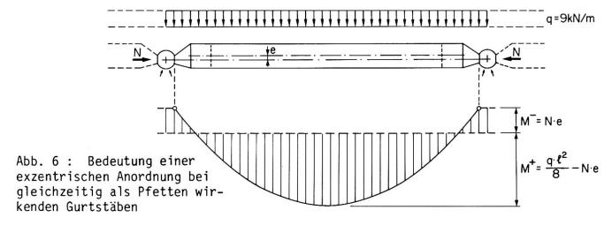
Die Bedeutung des exzentrischen Anschlusses und der Einfluss der Querlast auf die Tragfähigkeit des Stabes (nur Normalkräfte) wurde experimentell untersucht, wobei die beiden Grenzfälle gemäss Abbildung 7 geprüft wurden.
