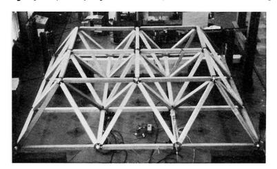
4 Pressen. Der Stabquerschnitt wurde generell zu 120 x 120 mm gewählt. Die höher beanspruchten Stäbe bestanden aus verleimtem Buchenholz; die restlichen aus normalem Brettschichtholz (Fichte). Die Bruchbelastung des Stabrostes betrug 1200 kN. Der Bruch wurde durch ein Knickversagen eingeleitet.
