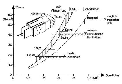
Abb. 2: Ueberproportionale Steigerung der Tragfähigkeit von Zuganschlüssen mit zunehmender Dichte des Holzes; Spannungswerte bezogen auf Bruttoquerschnitt
