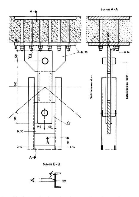
Fig. 5 Anschluß des Dachverbandes am Kernbauwerk
