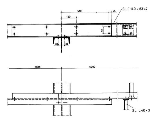
Fig. 2 Konstruktive Ausbildung der Pfetten
