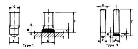
Fig. 1 Types de goujons filetés utilisés pour les essais.
