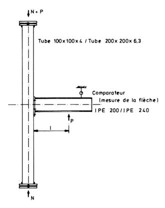
Fig. 5 Dispositif d'essai pour les assemblages poutre-colonne.
