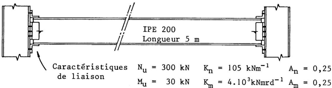
Figure 6 : Caractéristiques géométriques et mécaniques de la poutre.
