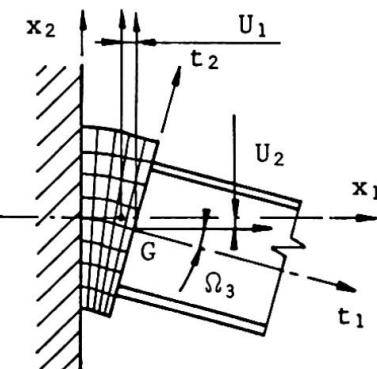
Fig. 3 : Macro-élément en configuration déformée
