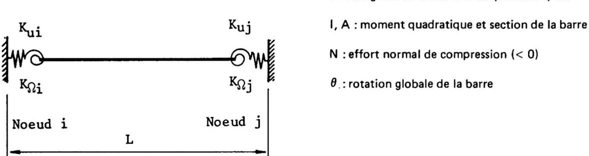
Figure 5 : Discrétisation de la barre et des assemblages aux extrémités.
