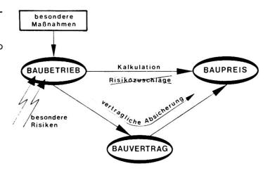
Abb. 1 Dreiecksystem Baubetrieb - Baupreis - Bauvertrag
