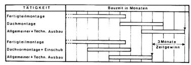
Abb. 5 Die Bauzeit bei einem Hallenbau wird dadurch verkürzt, daß die Dachkonstruktion vorgefertigt und eingeschoben wird.
