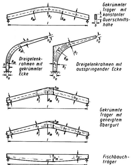
**Bild 1:** Träger und Rahmen mit gekrümmten Querschnittsrändern
