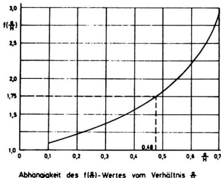
vom Verhältnis  $a/H$  bei einer zulässigen Querzugspannung von  $\text{zul } \sigma_{\perp} = 0,4 \text{ N/mm}^2$  und einer wirksamen Holzfläche  $A_w = w \cdot s_w$  ermittelt wurde. Da bei diesen Versuchen das Verhältnis  $D/H$  keinen feststellbaren Einfluß hatte, wurde es hier vernachlässigt.
