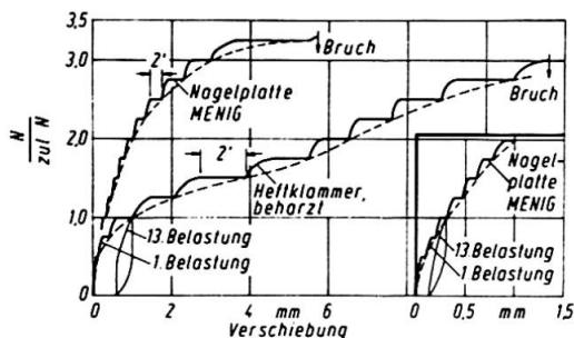
Bild 3: Kraftverschiebungsdigramme mechanischer Holzverbindungen
