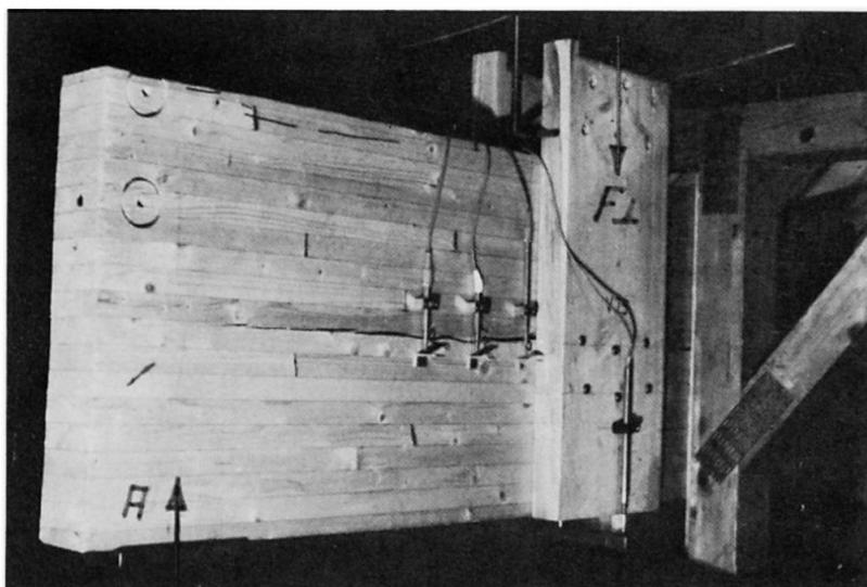
Bild 4: Versagen eines Stabdübel-Queranschlusses durch Querzugversagen des Brett-schichtholzes
