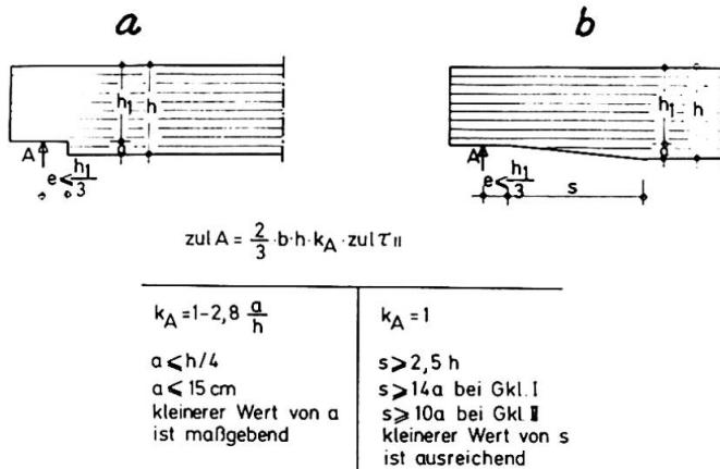
**Bild 7:** Ausgeklinkte Trägerauflager, Bemessungsgleichungen für die zulässigen Auflagerkräfte bei senkrechter und schräger Ausklinkung
