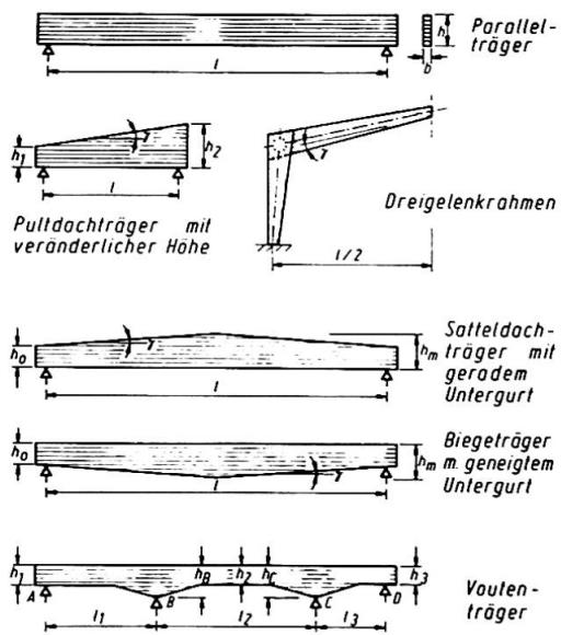
**Bild 2:** Brettschichtträger mit linear veränderlichen Querschnittshöhen
