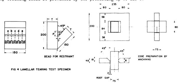
FIG. 5 DETAILS OF RESTRAINT CRACK TEST SPECIMEN
